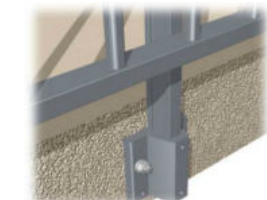
Pose en nez dalle double fixations.
