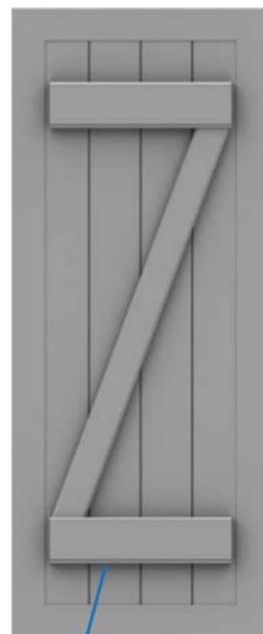
Rainurage vertical, barres et écharpes épaisseur 30 mm
